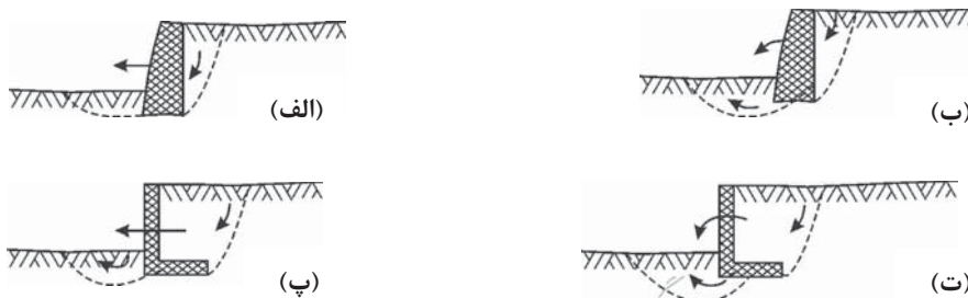
شکل ۶-۷-۲ نمونه‌هایی از حالت‌های حدی گسیختگی در شالوده دیوارهای نگهدارنده.
